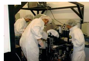
Prozessanlagen-Integration Integration Ihrer Prozessanlagen unter Reinraumbedingungen, Anschluss der Medien und Inbetriebnahme der Anlage
