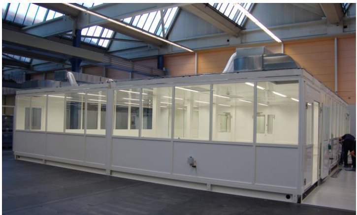
Reinraum Container GMP 150m 2 bestehend aus 5 Einheiten à 2,5m x 12m
